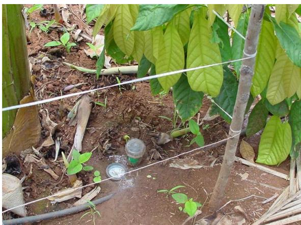
Figura 7 – Tensiômetro.
