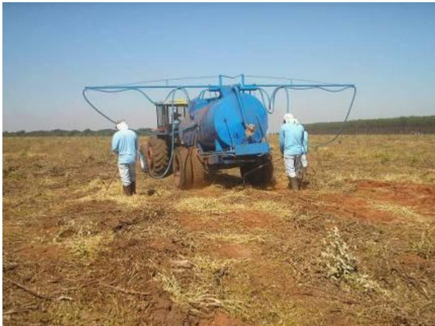
Carreta-pipa aplicadora de Gel: 11 kg de gel em 4.000 L água. Coveamento e aplicação de 01 L de solução pré-plantio (uma hora antes do plantio)
