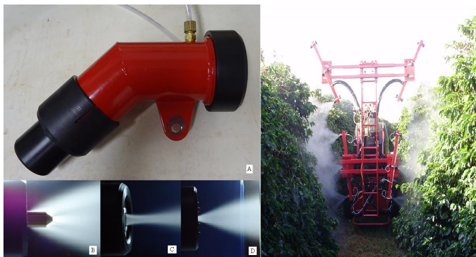
FIGURA 1. Bocais pneumáticos avaliados: corpo do bico (A), jato plano (B), jato cônico (C), AT-1000 (D) e pulverizador de volume ultra-baixo. Jaboticabal-SP, 2013.
