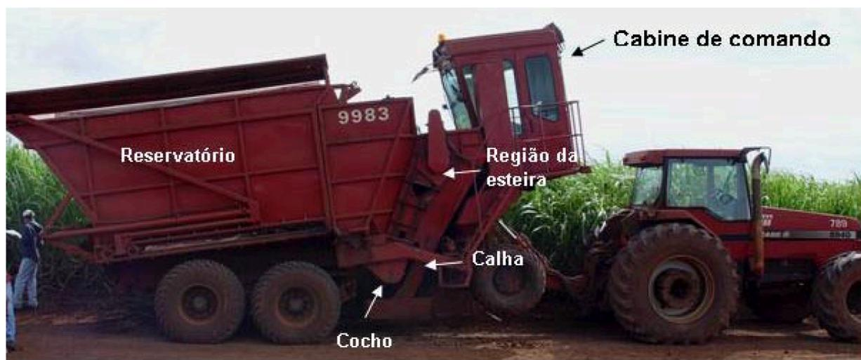
**Figura 1.** Máquina de plantio mecanizado da cana-de-açúcar e algumas de suas partes constituintes, onde foi instalado o sistema de pulverização.
