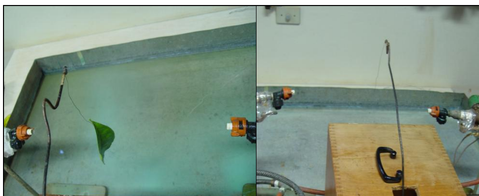
Figura 1. Equipamento de avaliação de retenção foliar das formulações de fungicidas.
