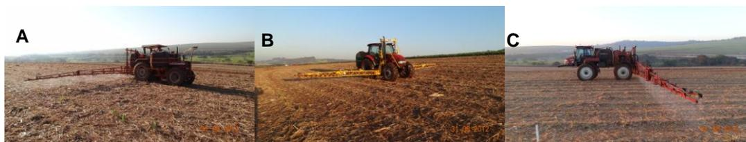
**Figura 1.** Pulverizadores avaliados no experimento, velocidade de trabalho e capacidade operacional: Albatroz - 8 km h<sup>-1</sup>, 7 ha h<sup>-1</sup> (A), Herbiplus G III - 10 km h<sup>-1</sup>, 9 ha h<sup>-1</sup> (B) e Patriot 350 - 14 km h<sup>-1</sup>, 18 ha h<sup>-1</sup> (C). Pradópolis-SP, agosto de 2012.
