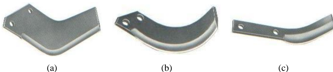
Figura 5. Tipos de facas: a) Faca em “L”; b) Faca em “C”; c) Faca reta.
