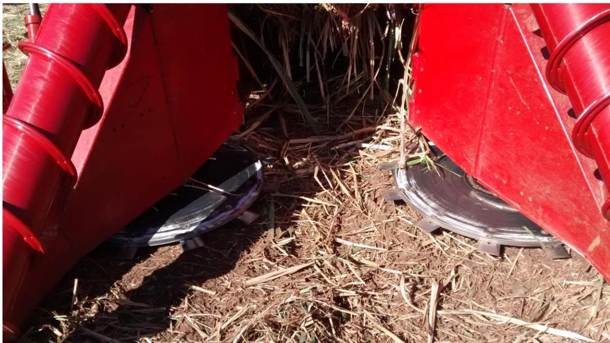
Figura 7. Mecanismo de corte basal de um modelo de colhedora de cana-de-açúcar.
