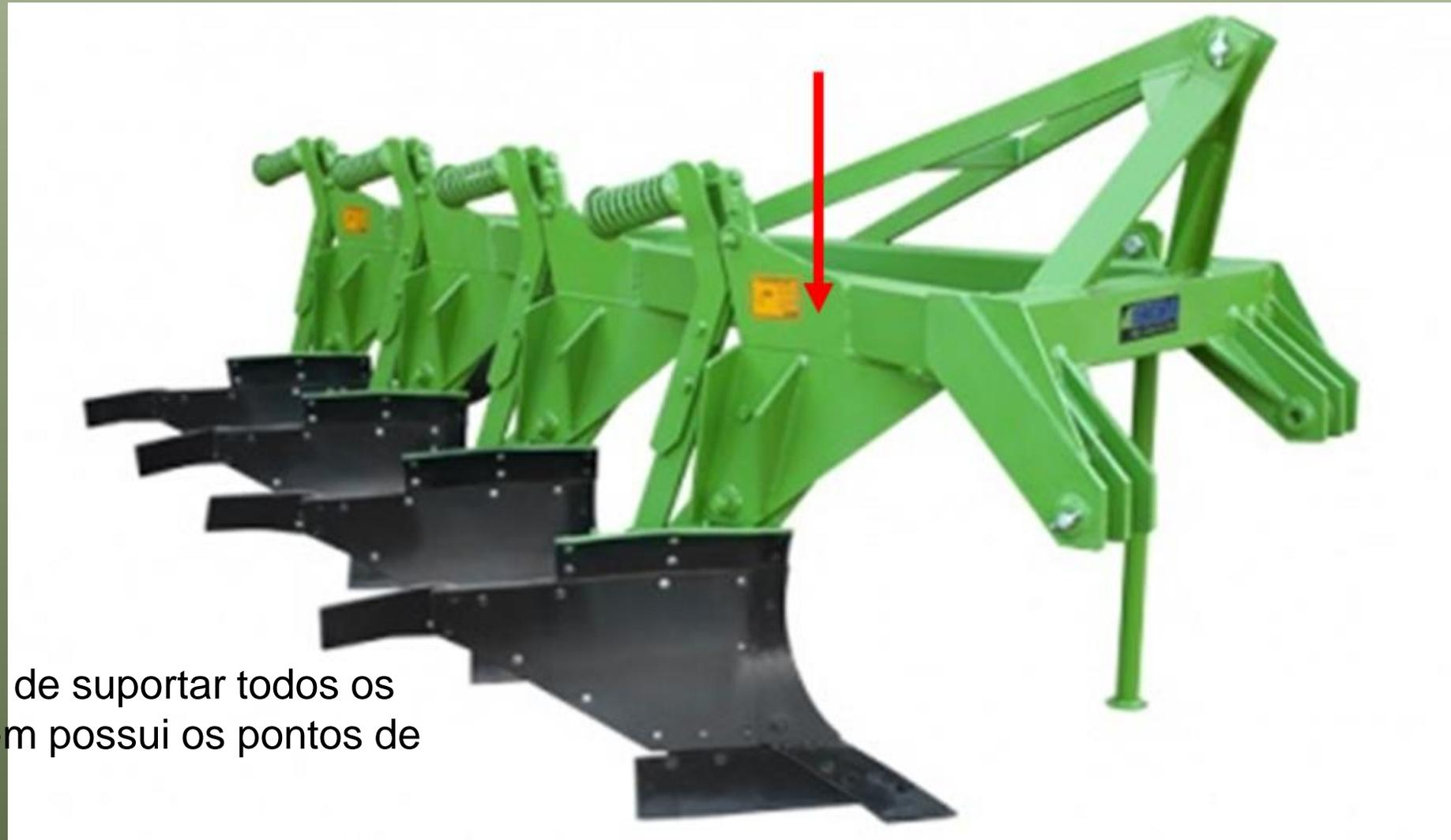
parte estrutural, que além de suportar todos os corpos de aivecas, também possui os pontos de acoplamento ao trator
