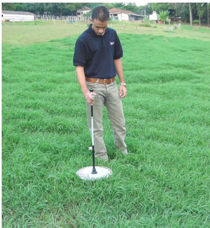
Figura 3. Medição com o prato ascendente ("rising plate meter"). O modelo da figura é comercial, mas há os de fabricação artesanal.
